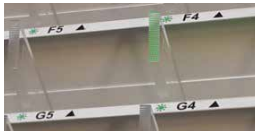
Láser color verde indica casillero donde se debe cargar el producto
